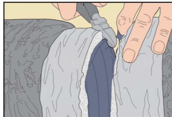
6 コアの硬鋼線をニッパで切断します。
