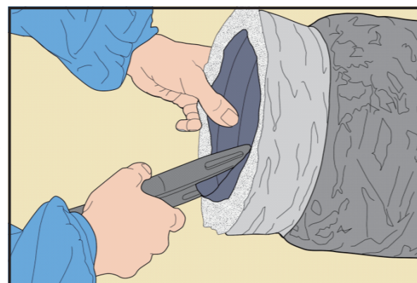
10 内側のコアに折り返して貼り付けます。 ※GWを露出させないことが大切です。
