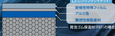
材料構成断面
