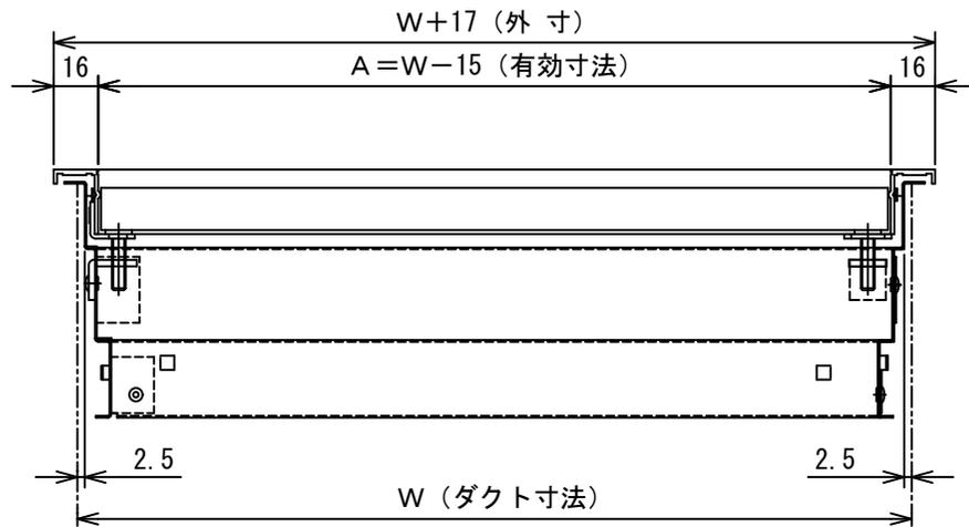
⚠ 注意：最大吹出風速  $V = 8.0 \text{ m/s}$  以下で御使用下さい。
