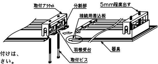
※分割型器具の分割部分の取付ブラケットの取り付けは、接続用差込板が無い側のみ取り付け御施工ください。
